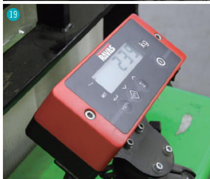
18～20 iForks検量データはハンディ端末で読んだパレットIDと紐付け、ハンディ端末経由でWMSへ
